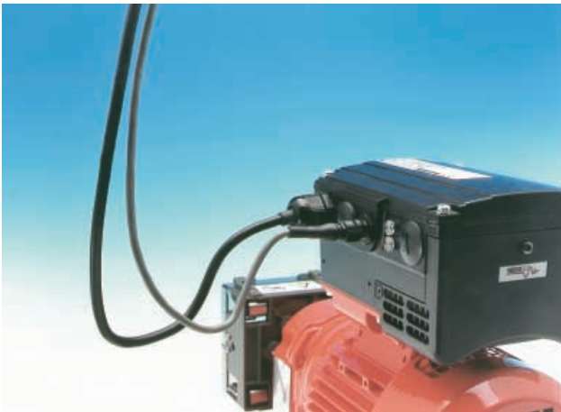
Kuva 1. Virta- ja ohjauskaapelin kytkeminen PL800:aan.
